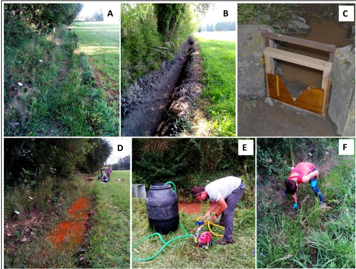
**Figure 5.2 : A : fossé A - B : fossé B - C : seuil triangulaire et sonde DIVER enregistrant les hauteurs d'eau - D : suivi des paramètres hydro-chimiques à l'aval - E : dispositif d'injection des traceurs - F : prélèvements des échantillons.**
