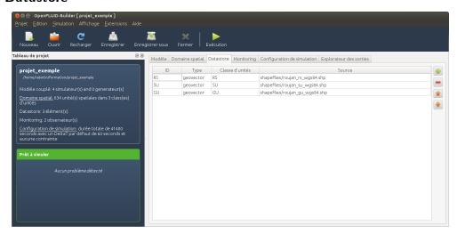
Le *Datastore* permet la mise à disposition des données associées au projet OpenFLUID . Pour ce projet, il contient les couches de données géographiques du bassin versant de Roujan.
