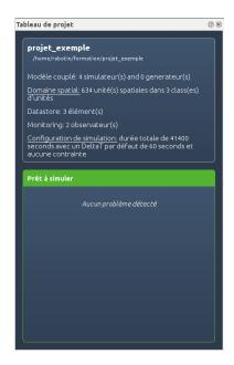
Des contrôles automatiques sont ainsi effectués en temps réel sur la validité et la bonne paramétrisation du modèle, la validité du domaine spatial, la configuration des sorties et de l'exécution. Dans le cas où l'indication de couleur est au rouge, la simulation ne peut pas s'effectuer.
