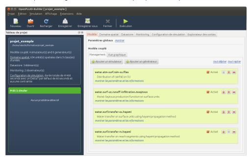
La partie *Modèle couplé* et son onglet *Management* permettent d'ajouter de nouveaux simulateurs, d'en enlever et de modifier leur ordre dans le modèle. Il permet également d'accéder aux informations de chaque simulateur (auteurs, description du rôle du simulateur, documentation sur les paramètres et les variables). La partie *Paramètres globaux* permet d'accéder et de modifier les paramètres globaux du modèle et des simulateurs.
