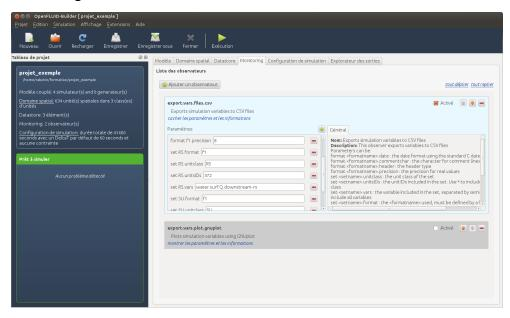
Cet onglet permet la gestion sélective des sorties de résultat extraites de la simulation via la configuration d'observateurs. Le format de sortie voulu (partie *Ajouter un observateur*) ou les unités et les variables désirées (partie *Ajouter un paramètre*) peuvent être paramétrés.
